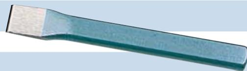
*Articolo:***C 3602/4 da 200 mm****Descrizione tecnica:***DIN 6453**In acciaio autotemprante al Cromo-Vanadio**Esecuzione verniciata**Testa indurita, indeformabile**Sicurezza collaudata GS**A sezione rettangolare smussata**Lunghezza taglio 24 mm**Lunghezza totale 200 mm**Sezione 23x13 mm*
