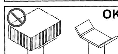
È vietato sostenere carichi di peso superiore alla capacità della colonnetta.
