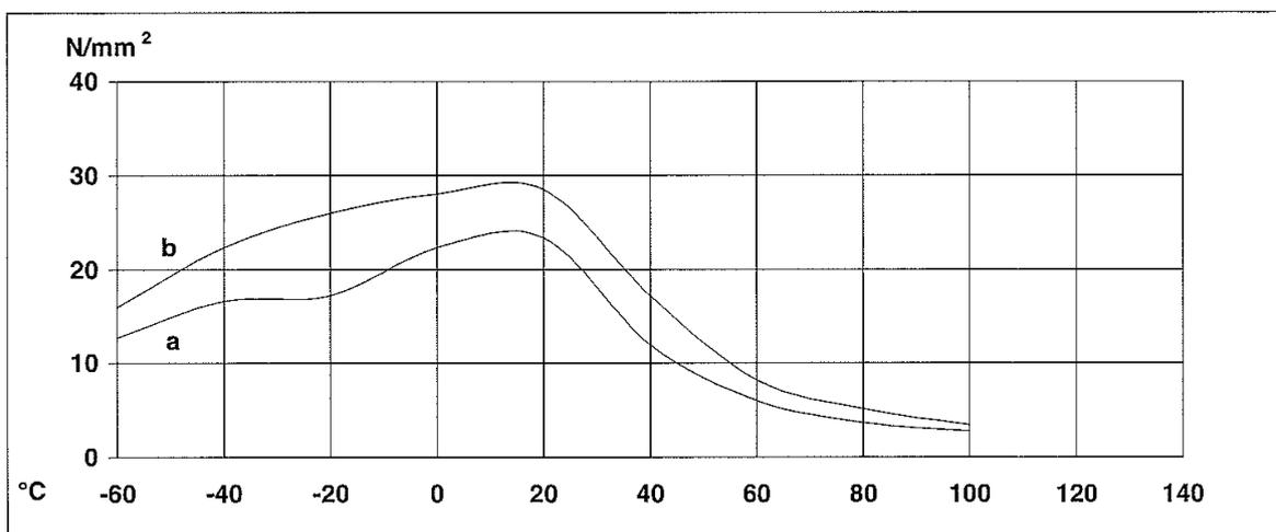
**Prova di spellamento da rullo (ISO 4578)** Indurimento 16 ore/40°C 5 N/mm
