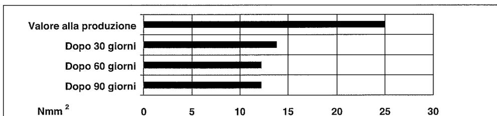
**Prova di fatica su giunture di sovrapposizione semplici (DIN 53285)**
